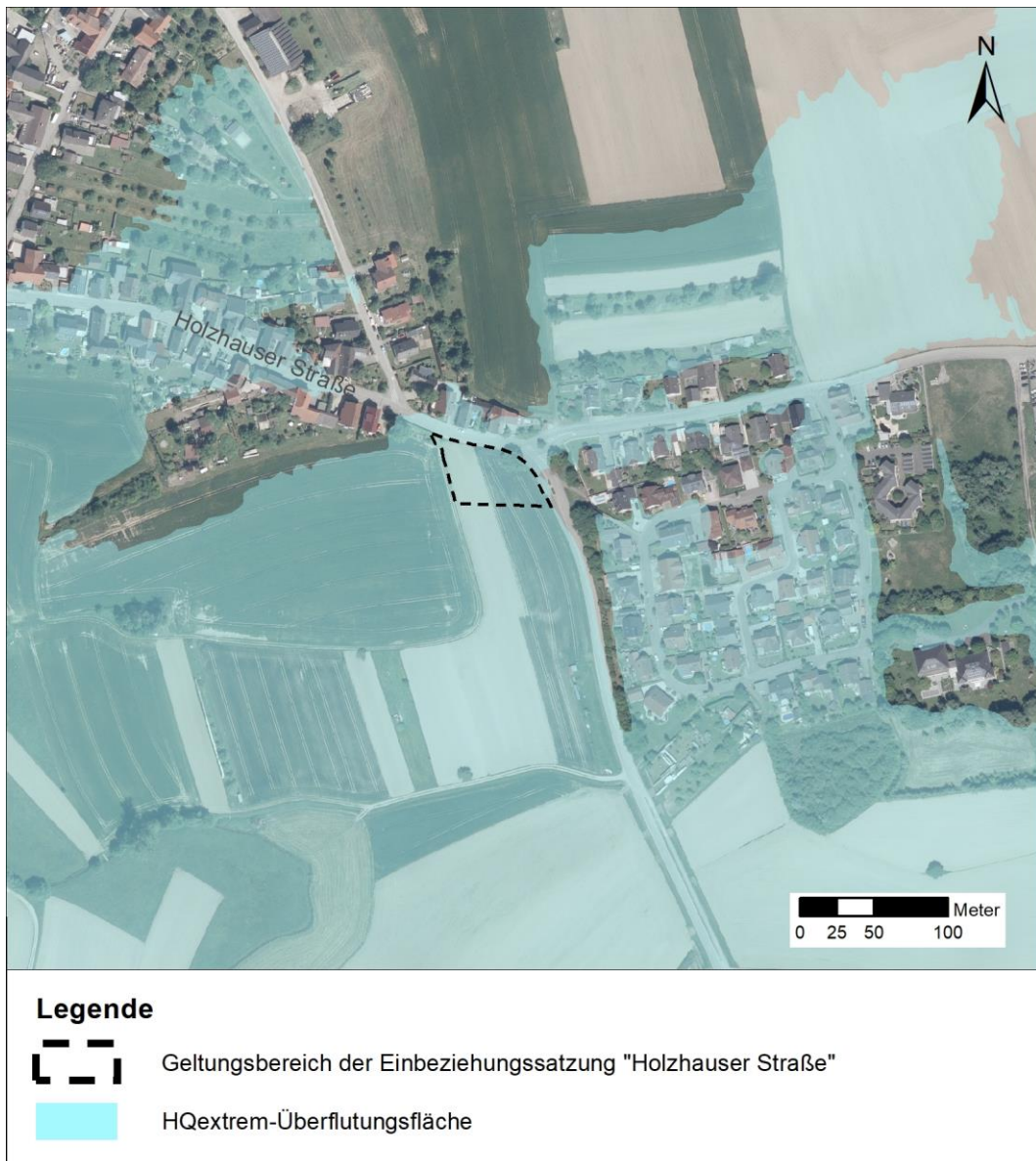
Abbildung 2.2-2. Darstellung der Überflutungsfläche bei HQ extrem .
